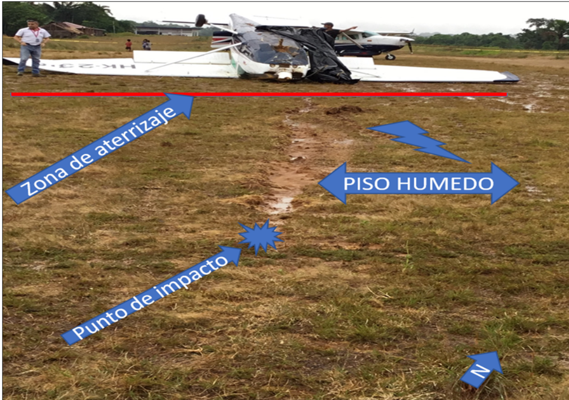
Fotografía No. 4: posición de impacto con el terreno
